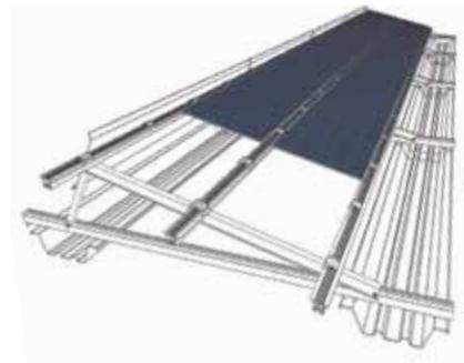
Aufgrund unterschiedlicher Bauformen sind verschieden hohe Ballastierungen möglich. Ideal auch als CompactVario mit Kopplung der Modulreihen, zur weiteren Reduzierung der Auflast.
