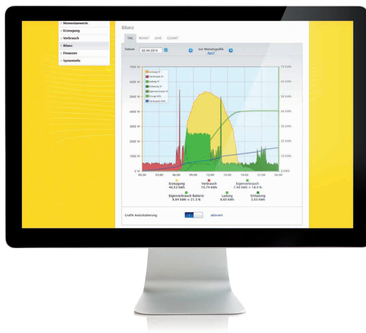
Tagesübersicht: Der Batteriespeicher wird mit der überschüssigen Leistung der PV-Anlage aufgeladen (Hellgrün) und bei Bedarf wieder entladen (Dunkelgrün) um den Bezug der Energie aus dem Netz zu vermeiden.
